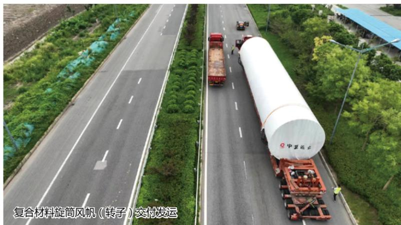
复合材料旋筒风帆（转子）交付发运
