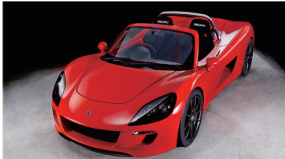
日前，帝人公司开发了全球首款模压成型聚碳酸酯（PC）无 A 柱汽车前窗。这款车窗被用于京都大学名下电动汽车制造商 GLM 公司的电动跑车 Tommykaira ZZ 上。
