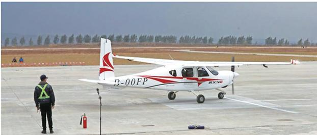
据了解，储能电池的能量密度与传统燃油有巨大差异，为保证飞机航时航程等设计指标，四座电动飞机装配了总容量近70千瓦时的系统动力电池装机，其电芯采用的是国内首个商业化应用的能量密度超过300瓦时每千克的电芯产品，在国际上处于领先水平。除了电动，这款飞机还有非常突出的特点——小而轻。RX4E飞机结构大范围使用碳纤维复合材料，占整机结构总重的77%。相比传统金属结构飞机，碳纤维复合材料重量轻、强度高、耐腐蚀。
